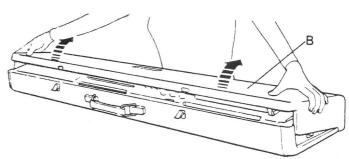
Die geschlossene Strickmaschine mit dem Tragegriff vom Bediener wegweisend auf einen feststehenden Tisch auflegen und den Gehäusedeckel wie abgebildet öffnen.
