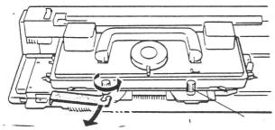
Transportsicherung (Feststellplatte) entfernen:
