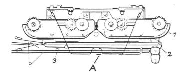
Haltefeder 'A' lösen und die im Maschinendeckel befindlichen Teile
